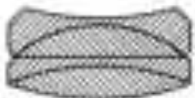
Universal-Anastigmat Linear ® F=1, F=2, F=3, F=4 5linsig, symmetrisch verbaut
